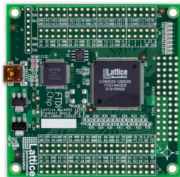
Figura 1: FPGA Lattice MachX02-1200ZE montada en una Breakout Board
