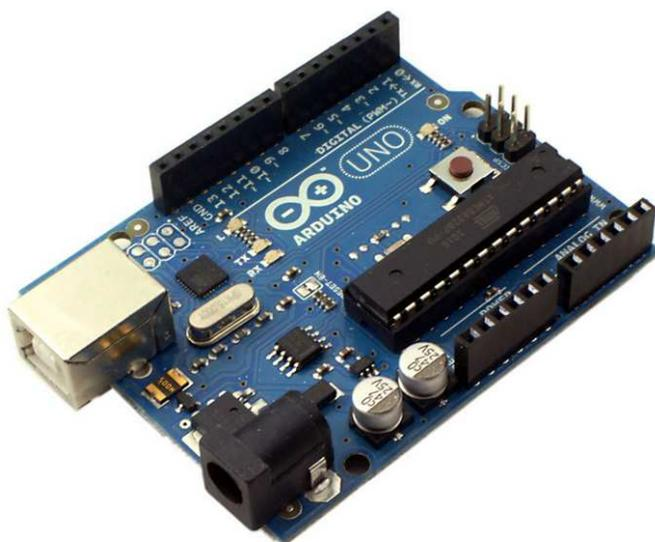
*Figura 5: Arduino UNO (microcontrolador ATmega-328)*
