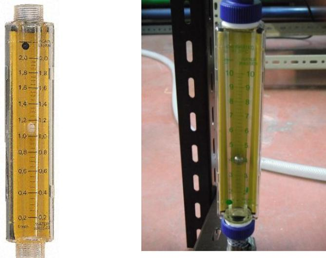
**Figura IV.16.** Caudalímetro de bola de la marca Parker.
