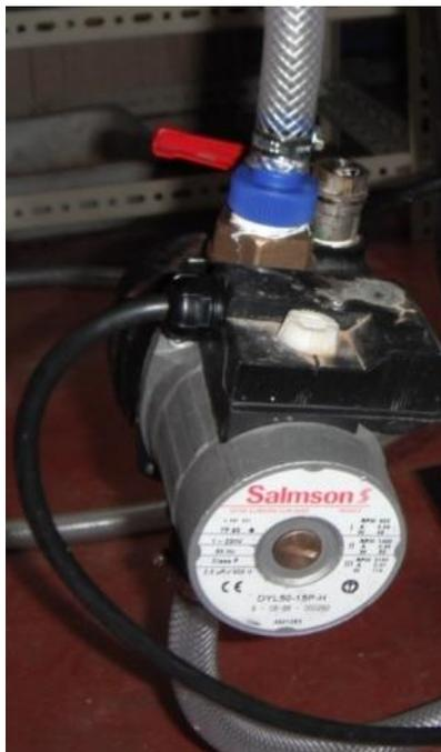
**Figura IV.11.** Bomba de agua Salmson utilizada en el banco de ensayos.
