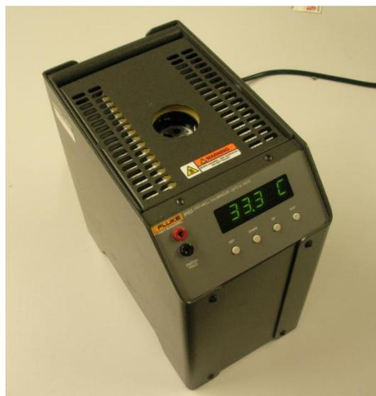
**Figura IV.18.** Horno de calibración FLUKE 9103.
