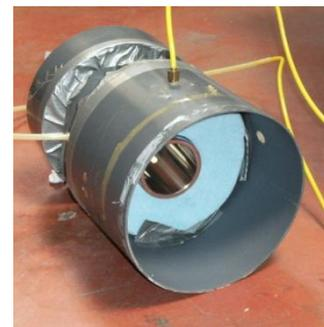
**Figura IV.22.** Tobera de referencia para calibración. Derecha: tobera montada.
