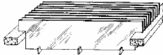
LÁMINAS DE FIBROCEMENTO, de 5 mm de espesor, con una superficie absorbente rugosa. Se apilan con espaciado horizontal de 19 mm.
