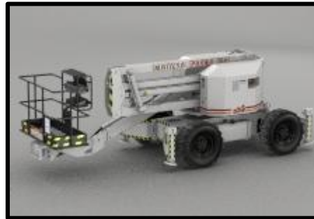
Ilustración 6. Plataforma elevadora autopropulsada. (Fuente: www.matilsa.es )
