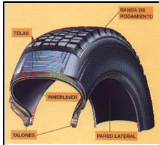
Ilustración 4. Esquema de un neumático radial (Fuente: Documentación interna Michelin)
