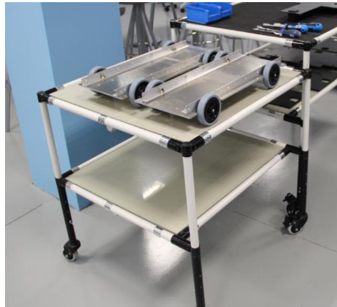
Figura 3.7.- Carro empleado en el transporte de producto intermedio entre células
