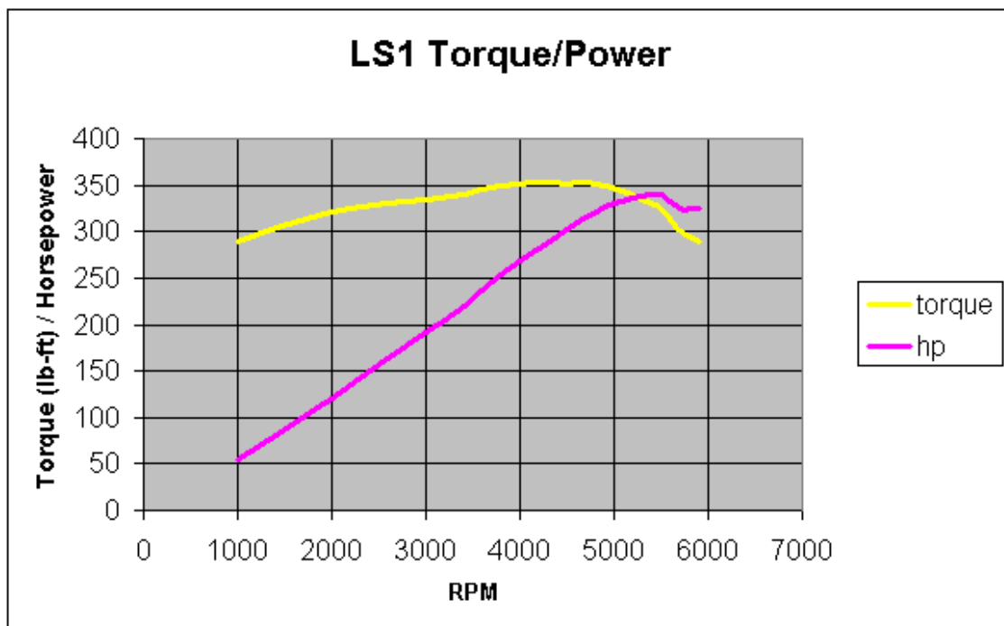
Figura 4.20. Torque en función de las RPM
