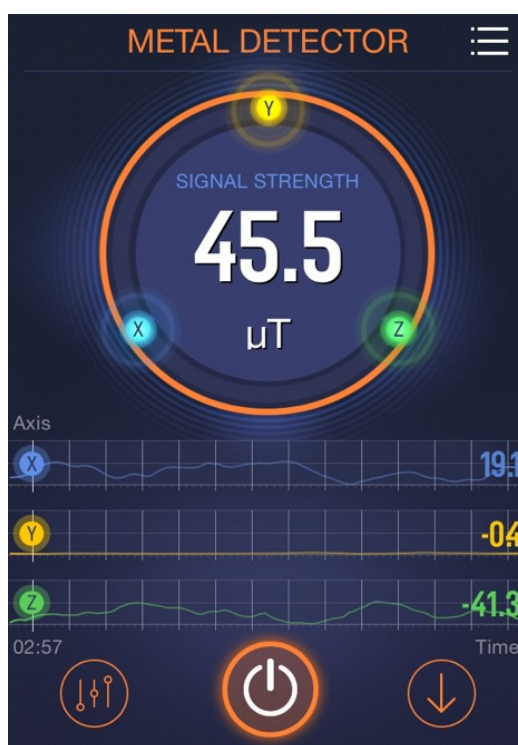
Figura 2.13: Aplicación MetalDetector midiendo la componente horizontal del campo magnético terrestre en el eje X .
