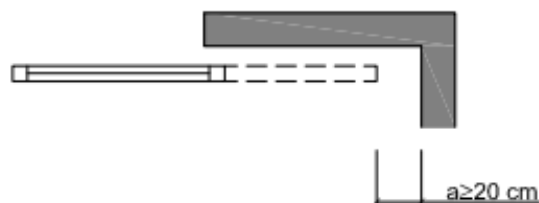
Figura 3. Holgura para evitar atrapamientos
