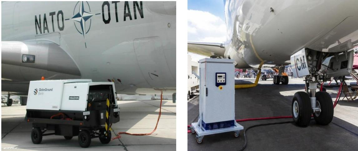
**FIG. 4.8. GPU motor diésel y Convertidor Estático.**
