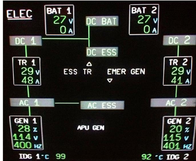
FIG. 6.2. Página del sistema eléctrico ECAM. A320
