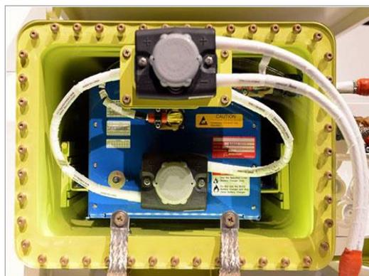
FIG. 4.14. Batería encapsulada del Boeing B-787.
