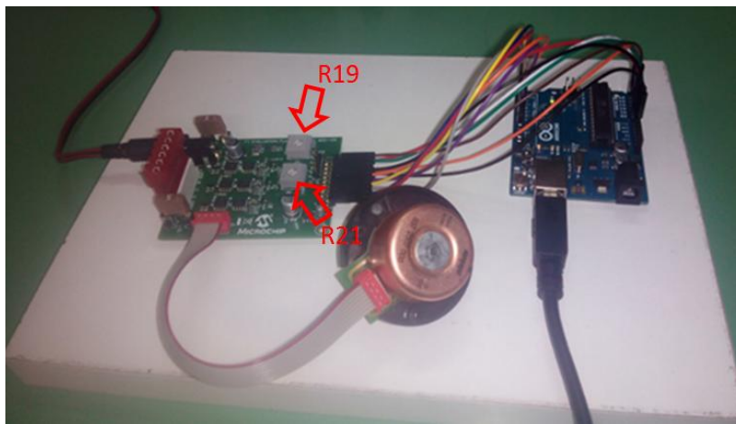
Figura 4.40 - Montaje con el esquema sensorless y el Arduino Uno
