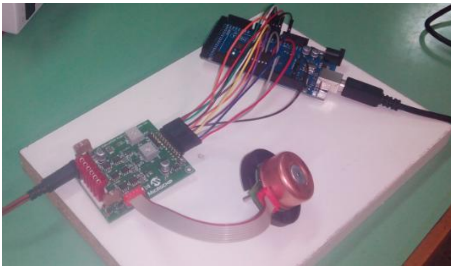
Figura 4.45 – Montaje con el esquema sensorless y el Arduino Mega 2560
