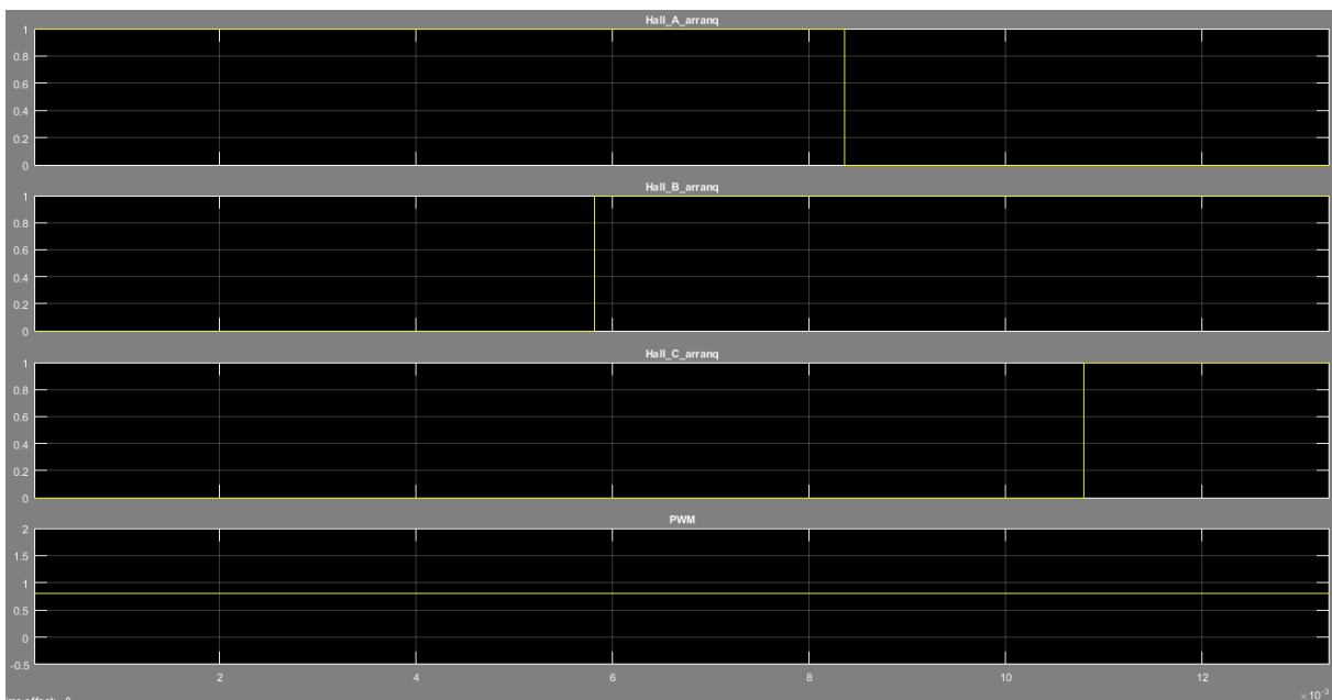
Figura 3.32 – Señales de los sensores Hall y de PWM generados en el bloque Arranque
