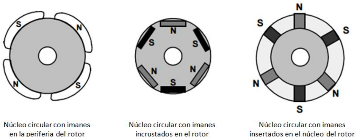
Figura 2.3 – Diferentes tipologías de rotor de motores BLDC
