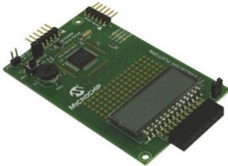
Figura 4.22 – Kit de evaluación DV164132, con microcontrolador PIC16LF1937
