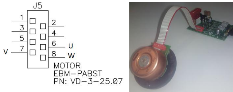
Figura 4.39 - Montaje y esquema de conexiones del bus del motor con la placa inversora
