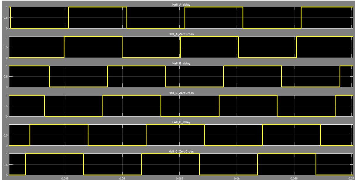
Figura 3.30 – Señales Hall producidas por el bloque 30_deg_delay
