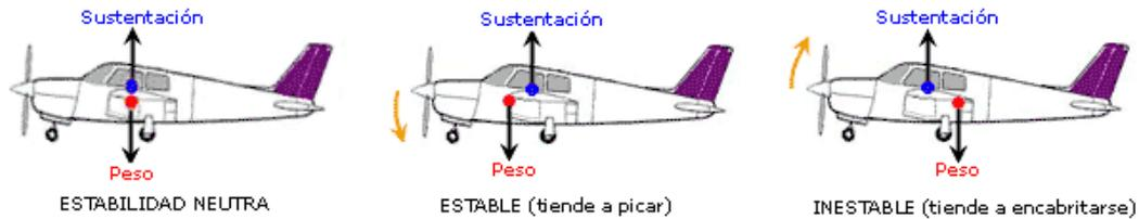
Figure 66: Comportamientos de un avión[24]
