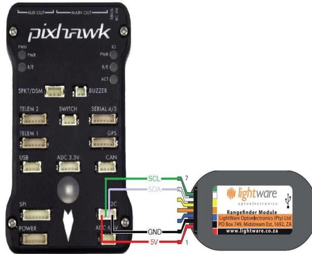
Figure 27: Conexión a Pixhawk mediante I2C
