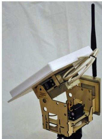
Figure 49: Cardán con antena direccional
