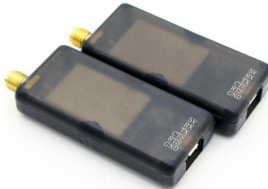
Figure 23: Telemetría a 433Mhz
