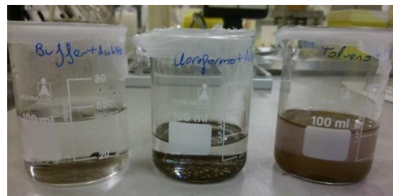
Figura 86. AuNPs-glicina en distintos disolventes (buffer fosfato, cloroformo y tolueno) una hora después tras ultrasonidos.
