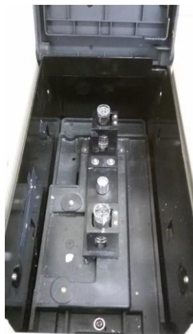
Figura 95. Colocación de las cubetas en el espectrofotómetro, la cubeta de abajo es la muestra y la cubeta de arriba es el blanco.
