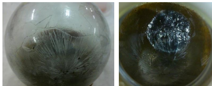
Figura 77. Aspecto de las AuNPs-glicina en estado sólido en el matraz de destilación de fondo redondo.
