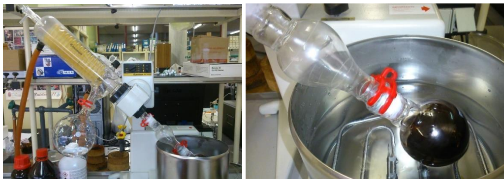
Figura 57. Etapa de concentración de las AuNPs-thiol en el rotavapor.
