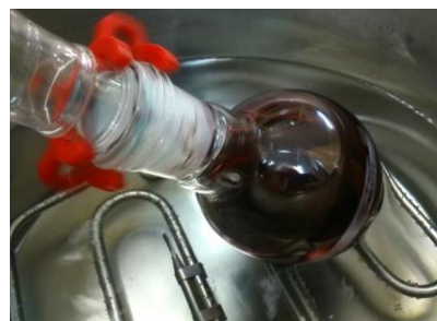
Figura 73. Etapa de concentración en el rotavapor de las AuNPs-glicina.
