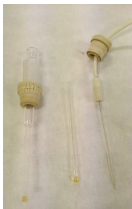
Figura 45. Material necesario para montar un RE.
