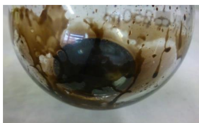
Figura 58. Volumen final de las AuNPs-thiol tras la etapa de concentración en el rotavapor.
