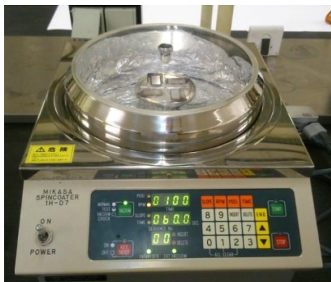
Figura 41. Equipo Mikasa Spincoater 1H-D7.
