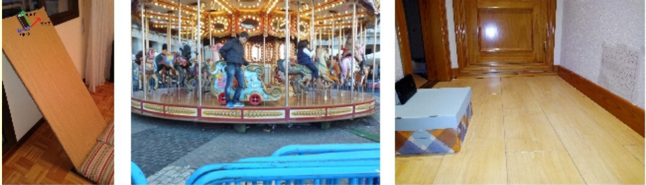
Fig. 8. Ejemplos de experimentos realizados por los alumnos de bachillerato usando sus smartphones: Medida del coeficiente de rozamiento de varias superficies a partir de la aceleración de caída, determinación de la velocidad de giro y aceleración centrípeta en un tiovivo y estudio del movimiento parabólico de un cuerpo mediante grabaciones con la cámara del smartphone [35,36,37,38].
