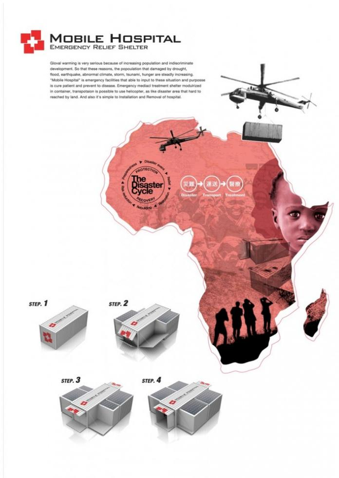
Kukli Han ha optado por la utilización de container para su hospital porque es lo suficientemente resistente para ser transportado a cualquier parte del mundo a través de tren, camión, barco o helicóptero. El hospital es alimentado por paneles solares portátiles y cuenta con sala de rayos X, sala de examen, sala de operación estéril, área de recuperación, sala de espera y una sala para las defunciones.
