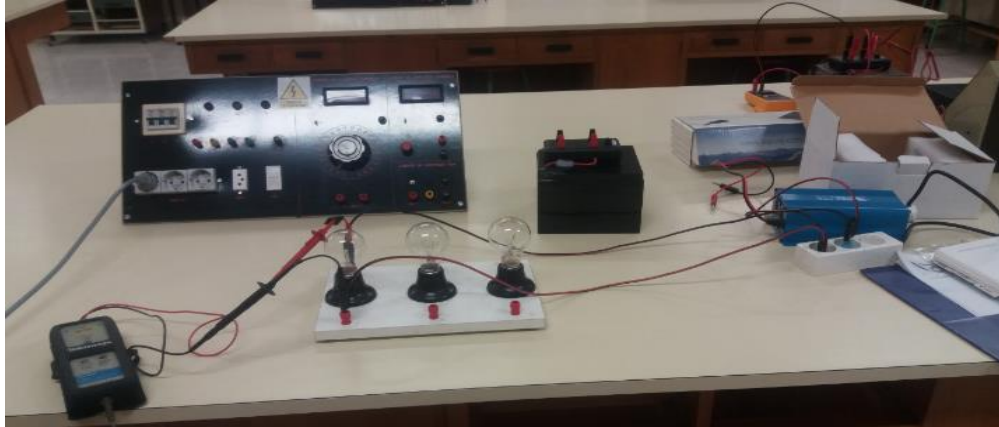
Figura 6.23 Implementación para analizar la frecuencia de conmutación del inversor
