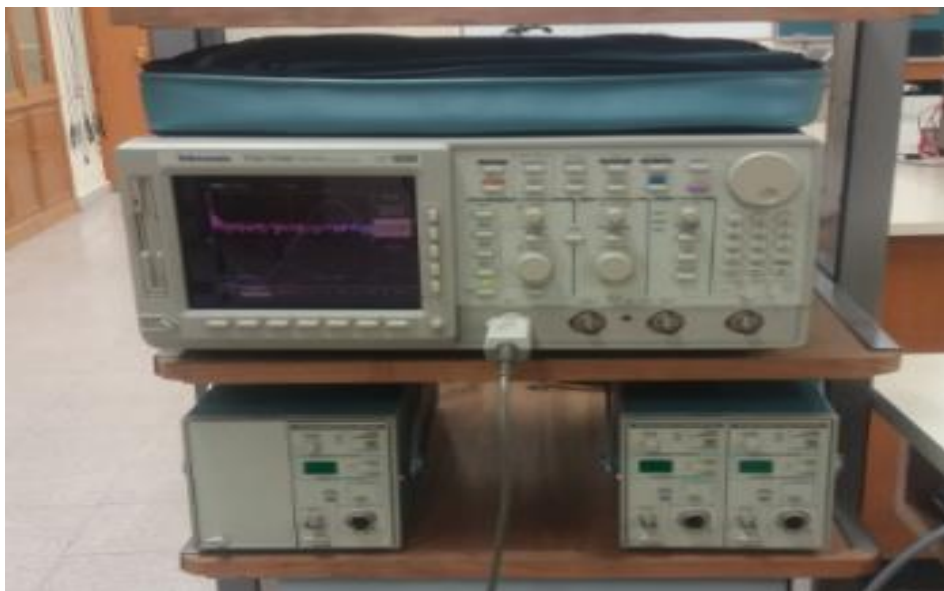
Figura 6.22 Osciloscopio con transformada rápida de Fourier
