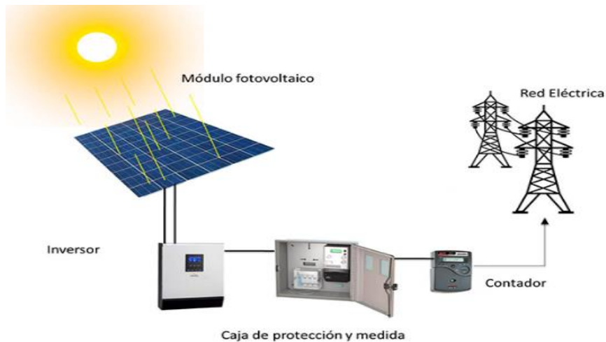
Figura 2.6 Esquema conexión de un sistema fotovoltaico conectado a red. Fuente [11]
