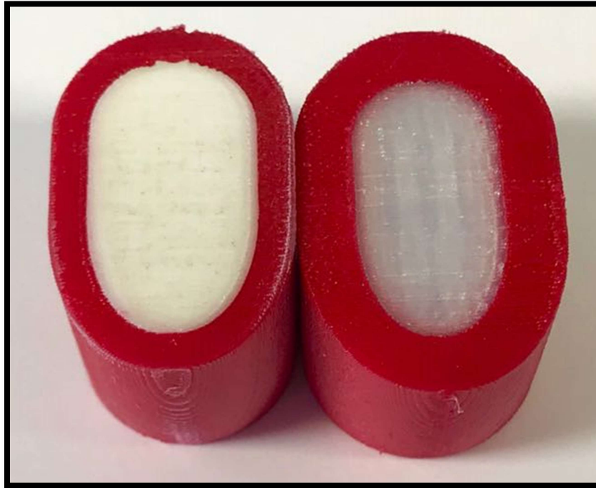
Figura 32. Comparativa de espesores del núcleo resistente. 4 mm a la izquierda y 6 mm a la derecha (elaboración propia)
