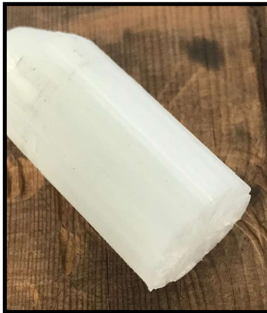
Figura 47. Sección de rotura de la empuñadura impreso en el eje z. (elaboración propia)
