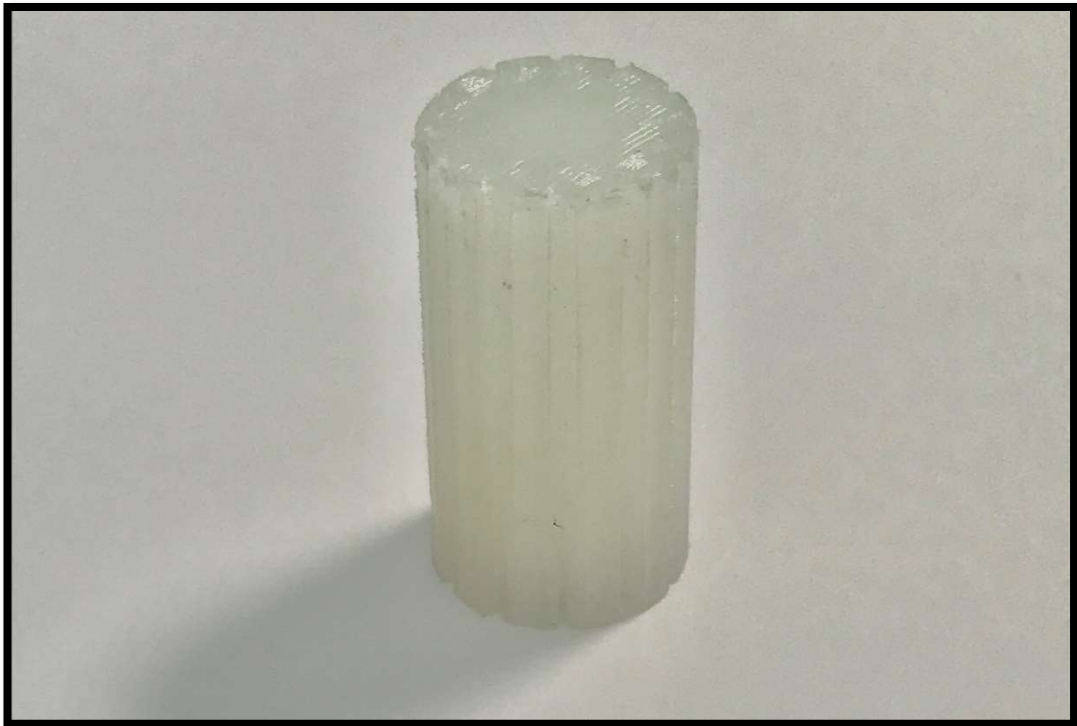
Figura 16. Bulón fabricado en Nylon. (elaboración propia)
