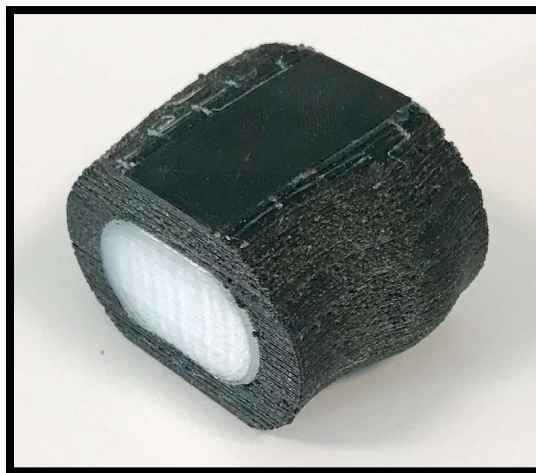
Figura 33. Sección de la empuñadura impresa de 6mm perspectiva isométrica. (elaboración propia)
