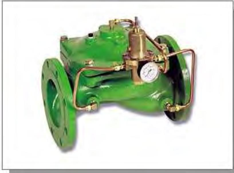
Como se aprecia en la ilustración, la válvula llevará incorporado un regulador de presión para que en todo momento la presión de entrada en el sector no sea superior a 3,5 Bares, que es como vimos en el anterior apartado, lo que permite el correcto funcionamiento del gotero autocompensante.
