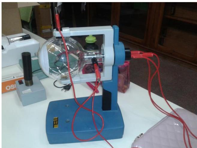
El objetivo principal es que vean que los electrones viajan en línea recta y que por ello se proyecta la sombra de la cruz en la pantalla fosforescente. Con intención de la siguiente demostración se comprueba que al acercar un imán la sombra de la cruz se deforma debido a la carga del electrón.
