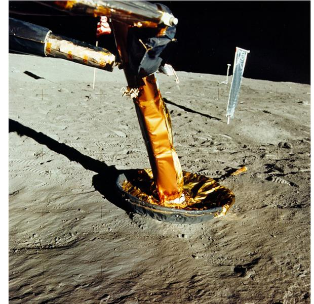
Imagen 15 : Soporte del módulo lunar y sonda de contacto (ApolloXI) 1969
