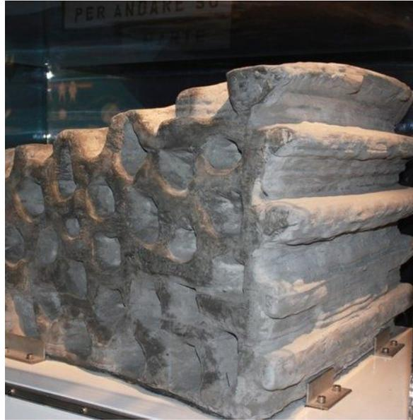
Imagen 62: Bloque de regolito lunar de 1,5T realizado mediante una impresora 3D por la ESA, a partir del material importado de la misiones Apollo.
