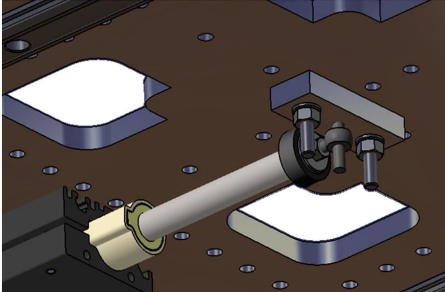
*Figura 13. Detalle de la unión tornillo de ojo - pasador cónico [10]*
