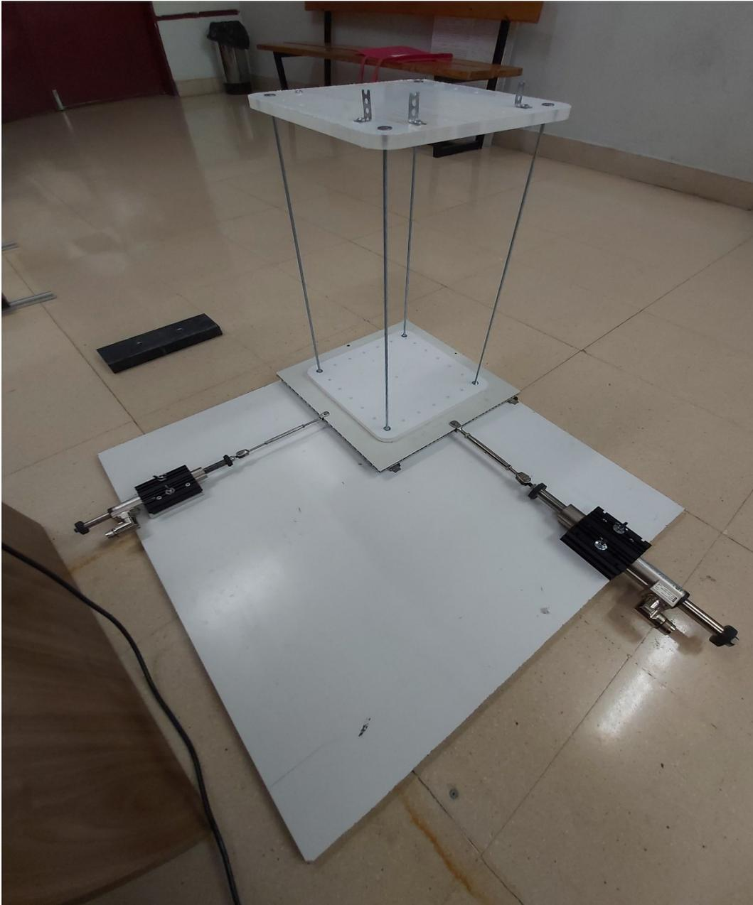
*Figura 60. Mesa sísmica completamente montada con una maqueta encima*
