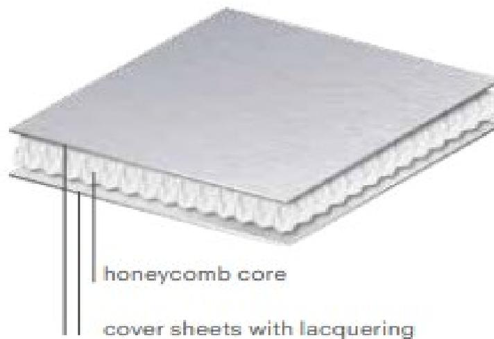
Figura 27. Composición de la placa de ALUCOBOND [17]
