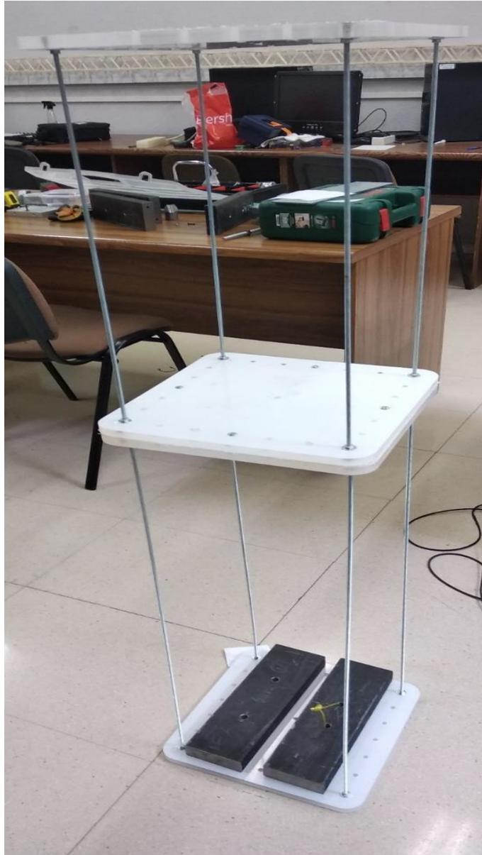
*Figura 14. Maqueta modular de un edificio multidireccional [11]*
