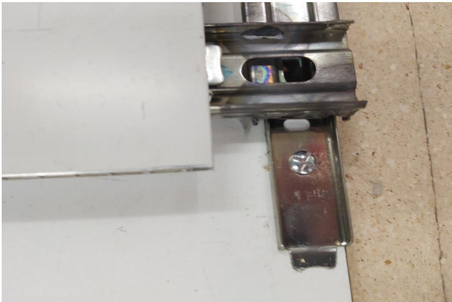
*Figura 58. Detalle de la unión de las guías a la base*
