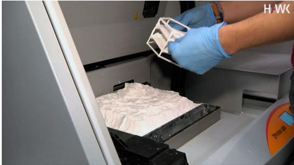
Ilustración 20 Pieza impresa mediante SLS [19]
