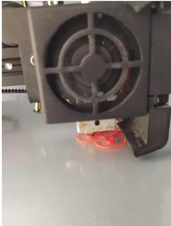
Ilustración 79 / Impresión en TPU de las almohadillas
