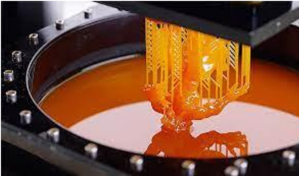
Ilustración 19 Pieza impresa mediante SLA [18]
