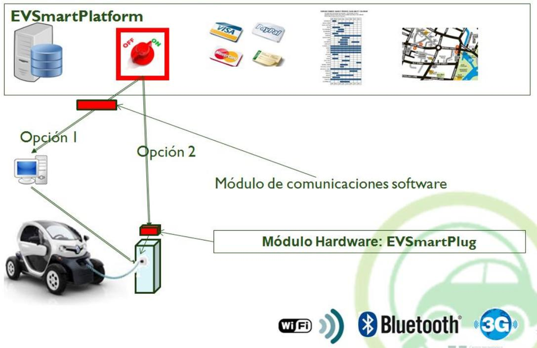
Figura 7. Dos formas de telecontrolar el punto de recarga.
