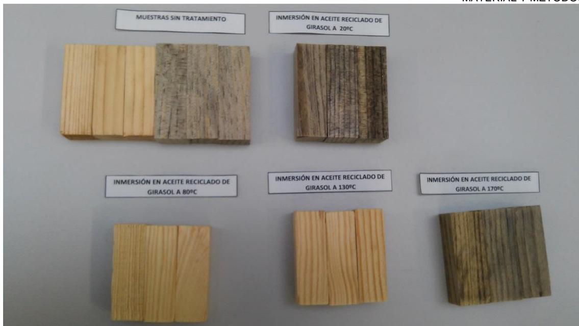
Figura 11: Probetas de *Pinus pinaster* después de los tratamientos.
