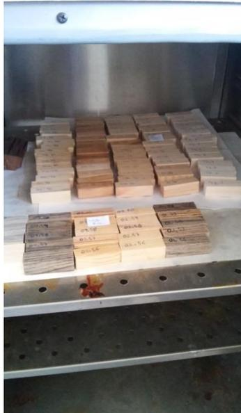
**Figura 15.** Probetas en la estufa para calcular las contracciones
