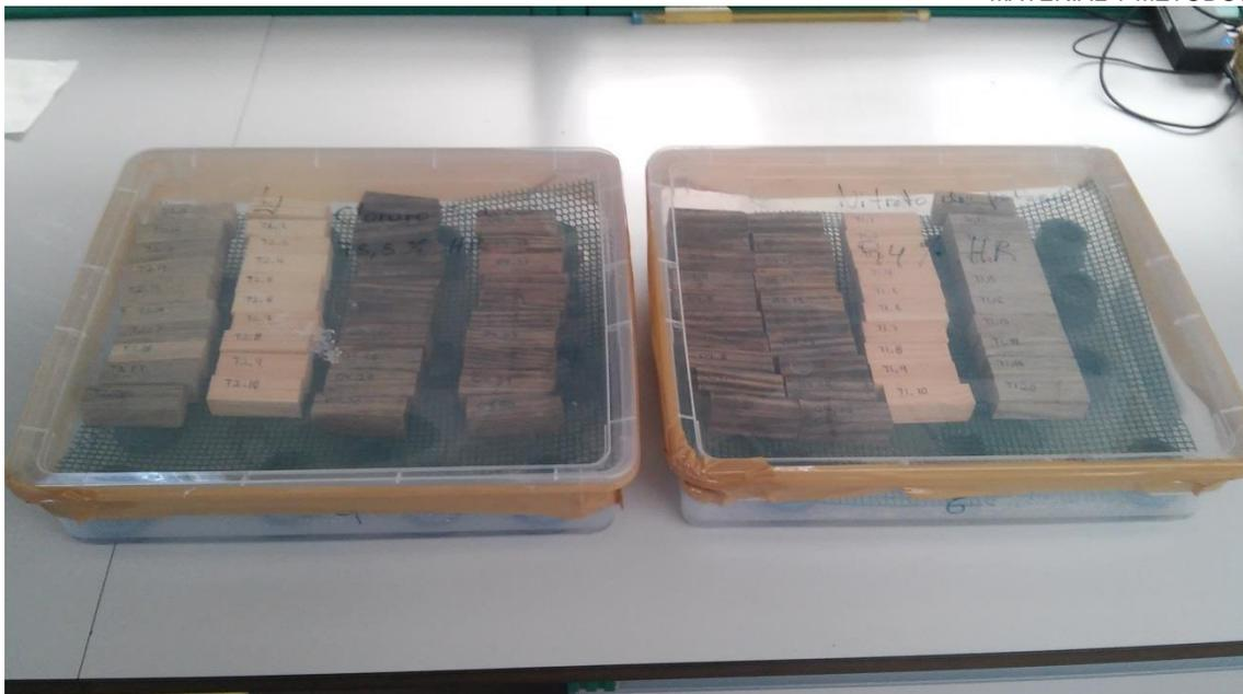
**Figura 13.** Probetas de *Pinus pinaster* en recipientes de plástico con sales de Nitrato de potasio y Cloruro sódico.
