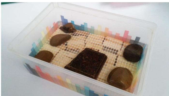
**Figura 14.** Probetas en agua durante 24 h.
