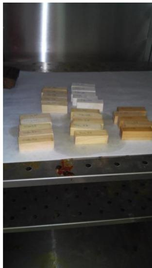
**Figura 12.** Probetas en la estufa para la determinación de la humedad.
