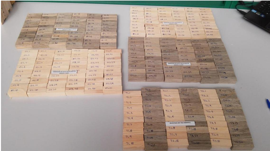
Figura 3. Probetas de madera de *Pinus pinaster* antes del tratamiento.
