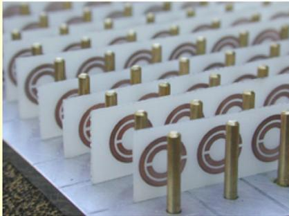
Figura 1. Estructura periódica, a base de SRRs y postes metálicos, propuesta por Smith *et al.* que se comporta como un medio LH a 5 GHz.
