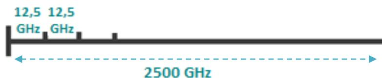
Figura 9. Capacidad máxima de un *lightpath* y de los slots que contiene .
