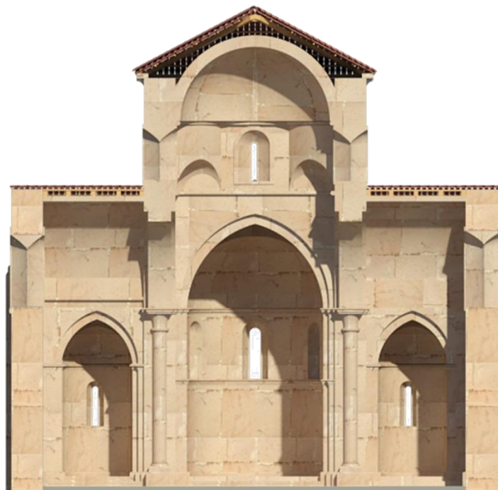
C) Corte transversal Este del Proyecto
