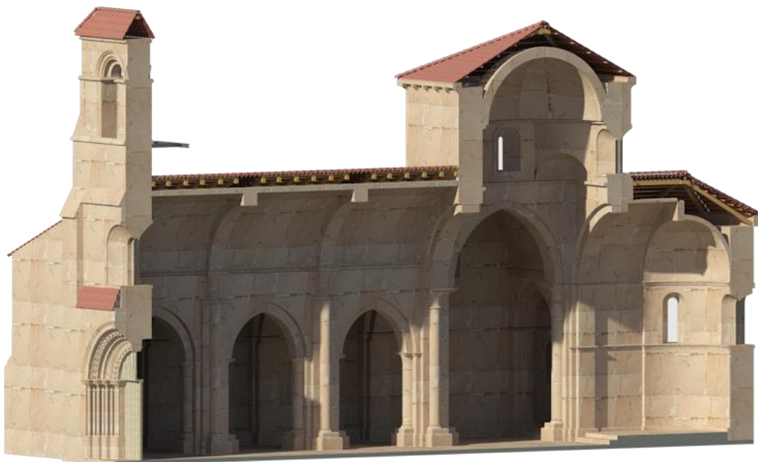
A) Corte pespectivado longitudinal de la Iglesia Santa María la Real de Mave. La incidencia del sol, la nobleza de los materiales y los detalles son un clon del original y esto es posible gracias a los avances q se están produciendo a nivel de representación 3D.
