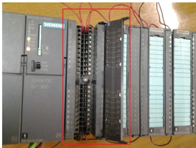
Figura 4: Módulo de salidas digitales alimentado a 24V
