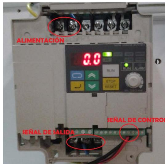
Figura 25: Conexiones Variador de frecuencia
