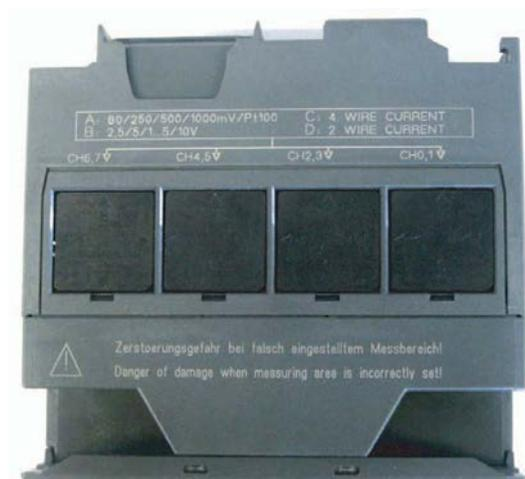
Figura 7: Tapas de configuración bloques analógicos
