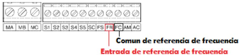
Figura 24: Terminales de conexión del Variador de frecuencia con el PLC
