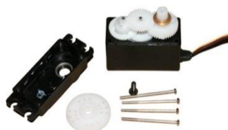
FIGURA 9: DESPIECE DE UN SERVOMOTOR
