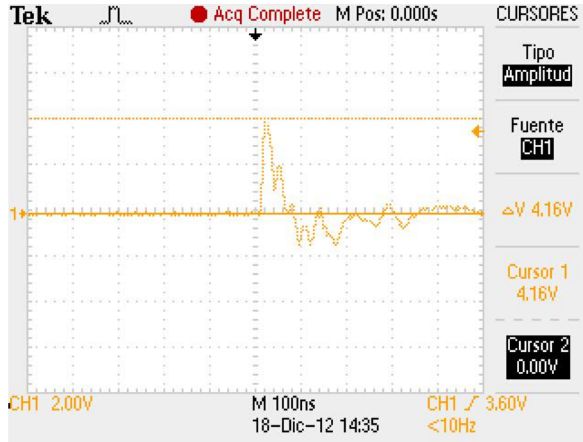
FIGURA 80: PICOS DE CORRIENTE EN LOS MOTORES I
