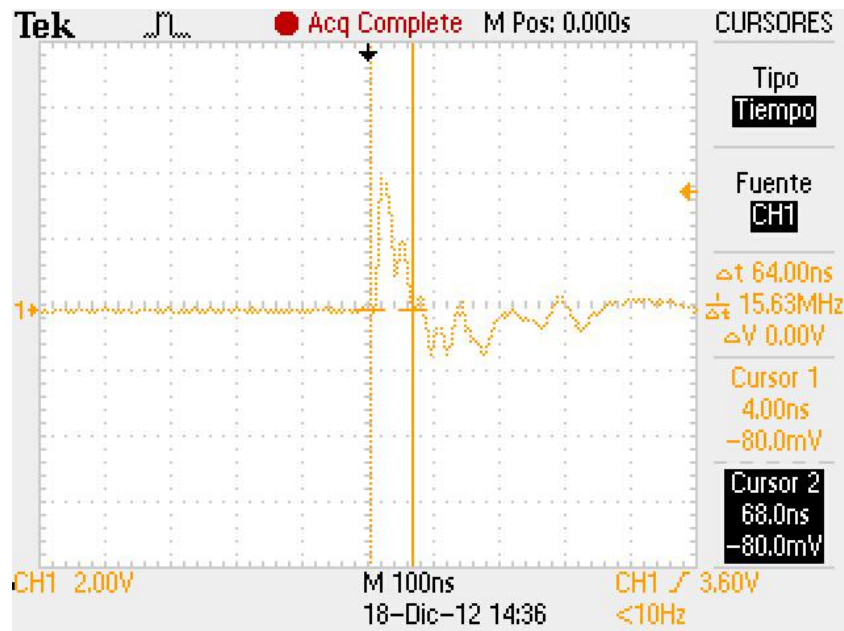
FIGURA 81: PICOS DE CORRIENTE EN LOS MOTORES II
