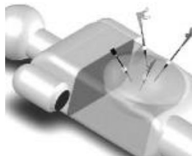
Figura 1. Representación esquemática de los dispositivos de entrada típicos (trócares) del instrumental laparoscópico [9]
