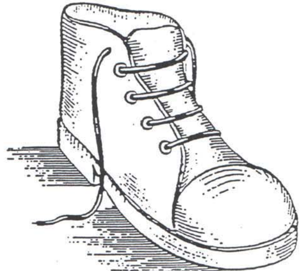
PUNTERA DE ACERO DE 1,8mm. DE ESPESOR PLANTILLA DE ACERO DE 0,50mm. DE ESPESOR. PUNTERA DE GOMA EXTERIOR.
