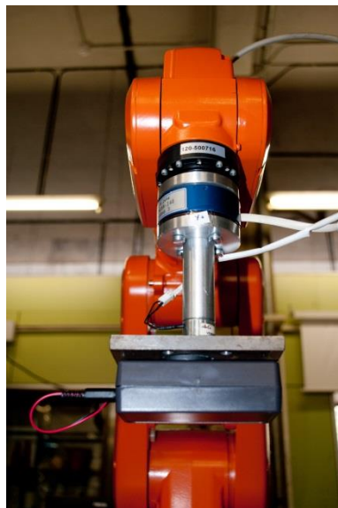
Figura 6. Detalle del dispositivo construido en el TCP del robot
