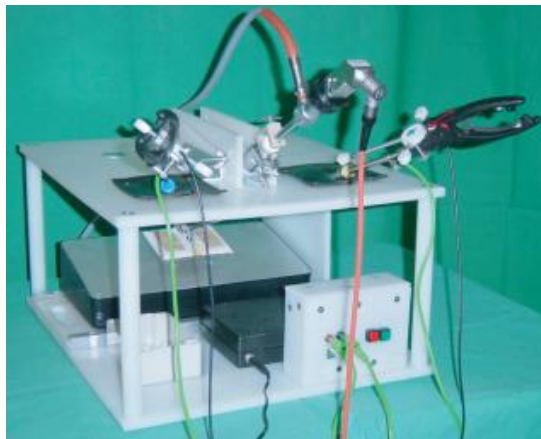
Figura 17. Sistema Zebri de ultrasonidos adaptado para la cirugía laparoscópica.
