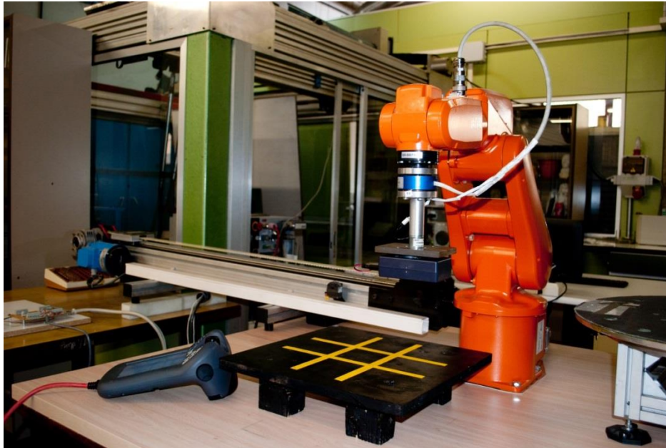
Figura 104. Robot ABB IRB 120 con el dispositivo instalado
