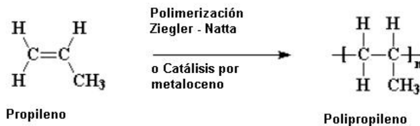
[Imagen 28: Estructura molecular polipropileno]
