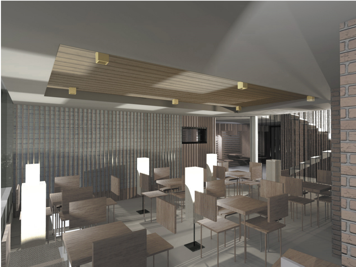
Figura 9. 4_ Resonador Deweton tipo A en techo sobre zona de restaurante en planta baja.
