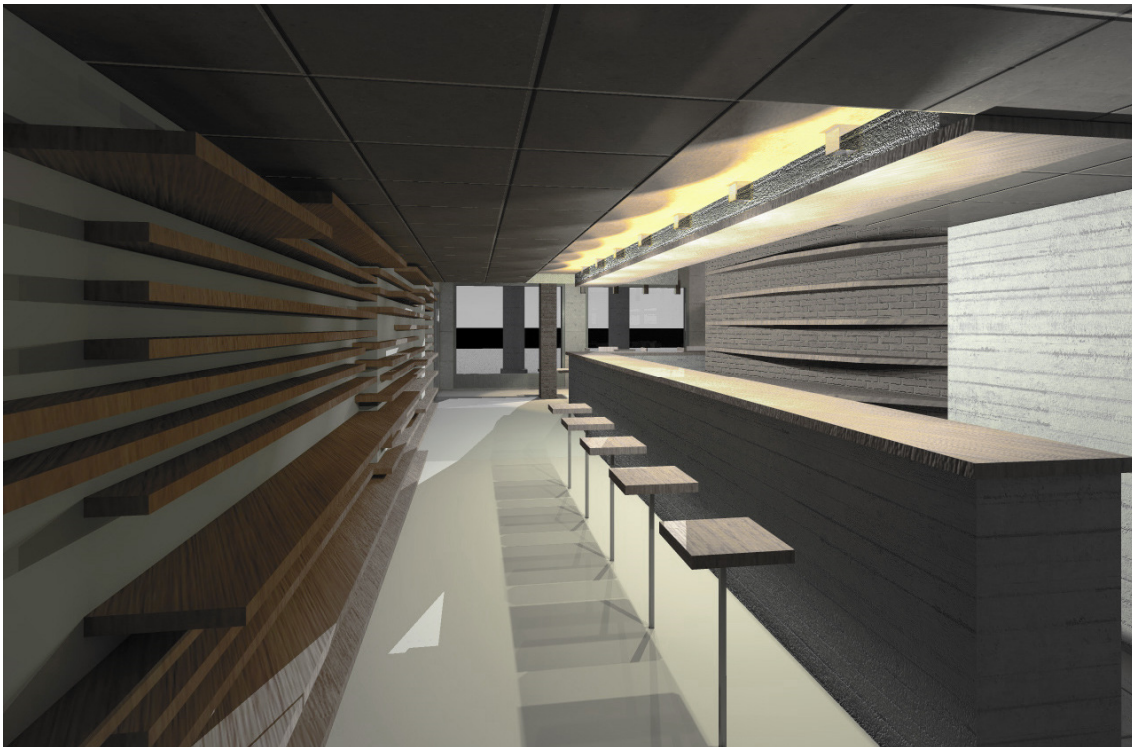
Figura 9. 5_ Lamas en pared y resonador Deweton tipo A en techo sobre taburetes en zona de bar.
