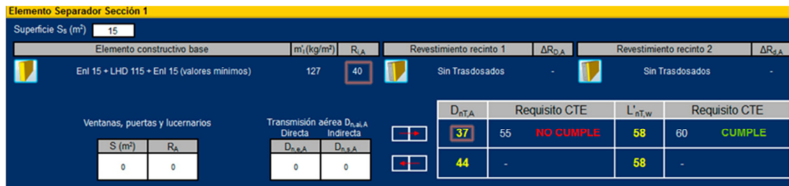
Figura A5. 2_Caso Local- Caja de escaleras. Valores R_A del elemento de separación, D_{nTA} y L'_{nTW} estimados.
