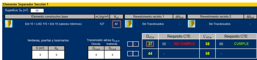
Figura 7. 29_ Caso Local- Caja de escaleras. Valores R_A del elemento de separación y D_{nTA} estimado.
