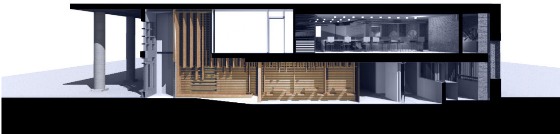
Figura 9.2_Sección longitudinal por acceso al restaurante; destacado lamas de madera en zona del restaurante planta baja.
