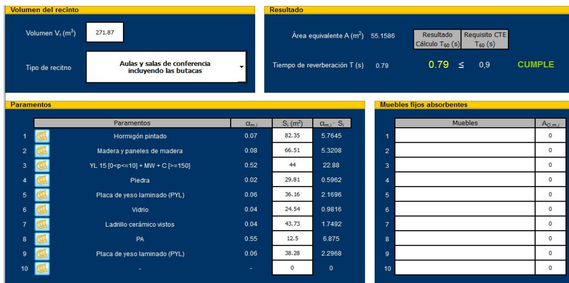
Figura 9. 14_ Tiempo de reverberación: zona de bar y pasillo de acceso a aseos (Planta baja) modificado
