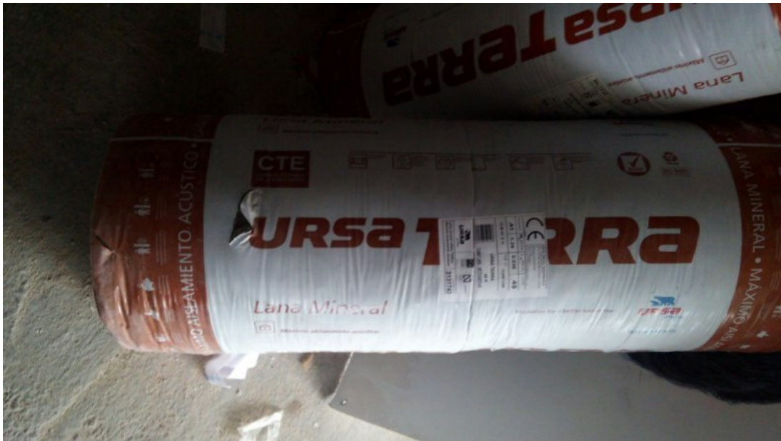
Figura 7. 12_ Imagen de uno de los rollos sobrantes del material utilizado para el aislamiento.
