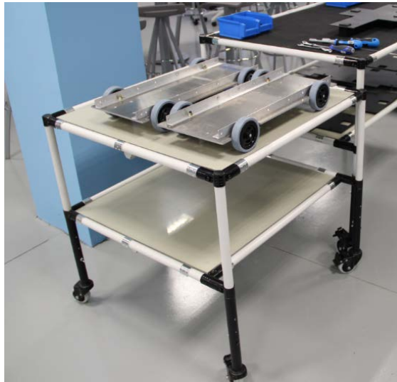
Figura 4.8. Carro transporte chasis de puesto uno a isleta de puestos dos y tres.
