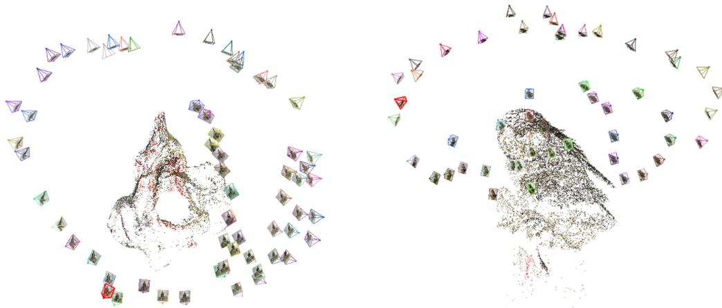
**Figura 3.3:** Distribución de fotos en los modelos 3D. Tiburón (Izquierda) y Búho (Derecha)
