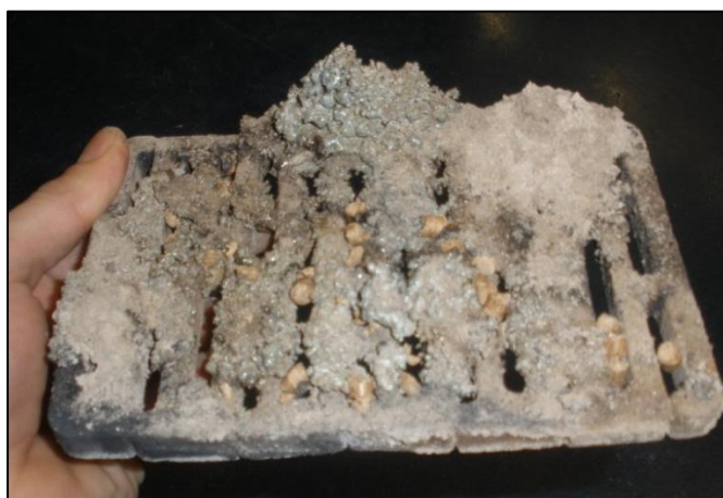
Figura 7.9 Situación final de la parrilla en el ensayo de la muestra 7.
