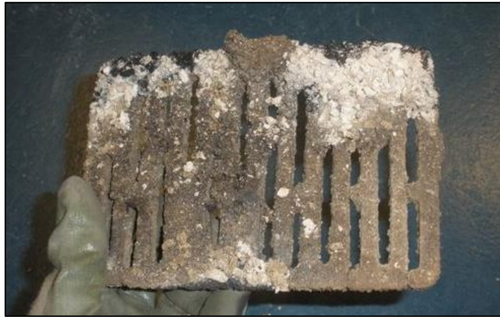
Figura 7.5 Parrilla al finalizar el ensayo de la muestra 6.
