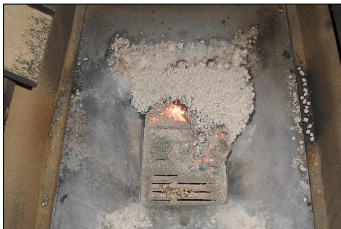
Figura 7.7 Parrilla al parar la caldera durante el ensayo de la muestra 7.
