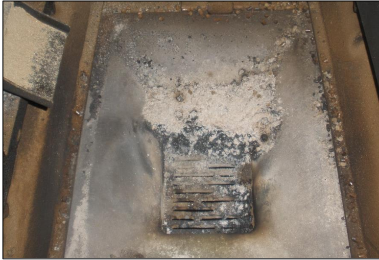
Figura 7.3 Inquemados y escoria al final la combustión de la muestra 5.
