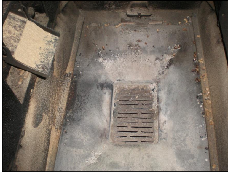
Figura 7.2 Estado final de la parrilla en la combustión de la muestra 4.
