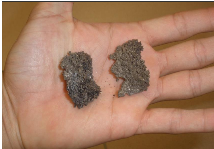
Figura 7.4 Detalle de la escoria generada por la muestra 5.
