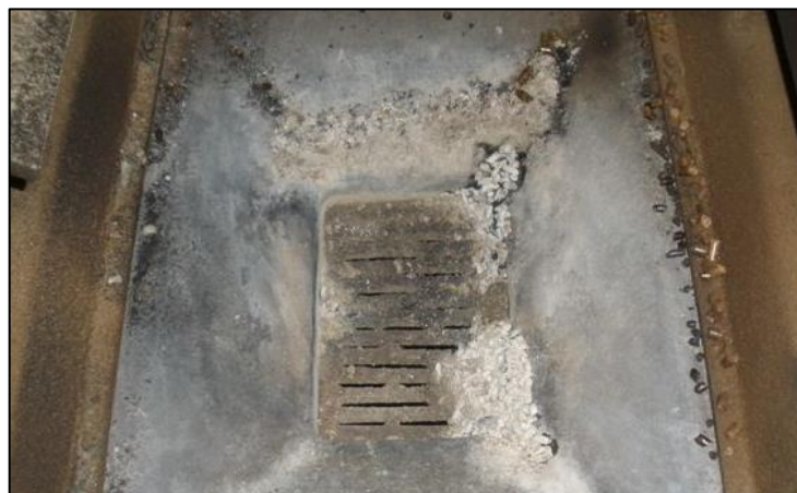
Figura 7.6 Cámara de combustión tras el ensayo de la muestra 6.
