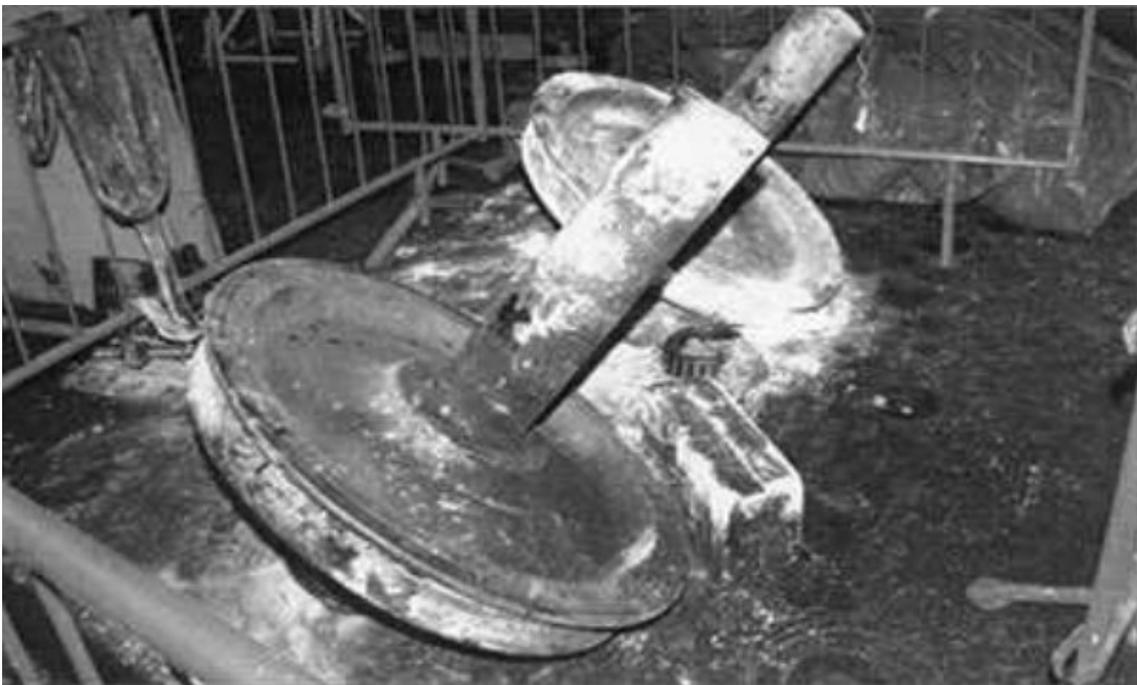
Figura 1.2: Eje de ferrocarril partido en un accidente de tren por fatiga del metal [2]
