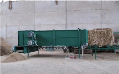
**Figura 4.4** Separador de balas de paja.<sup>[W-6]</sup>
