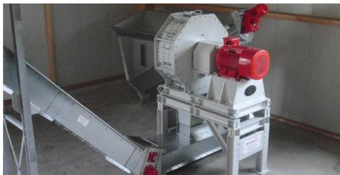
**Figura 3.3** Molino de martillos. <sup>[9]</sup>
