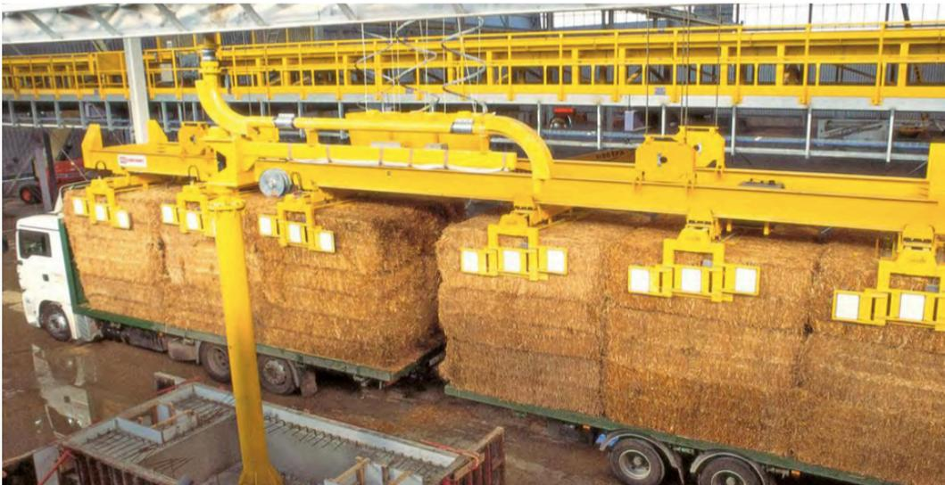
**Figura 4.3** Puente grúa usado en “Alternativa 1” (materia prima: paja de cebada).[W-5]
