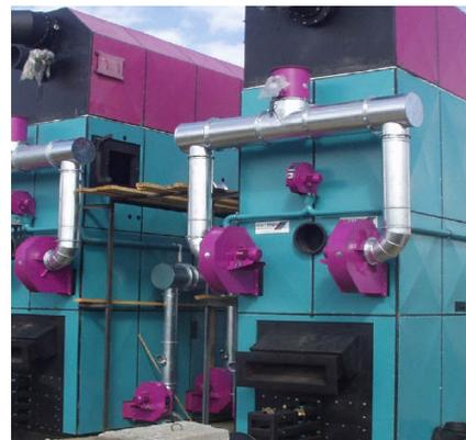
**Figura 3.5** Caldera de aceite térmico alimentada por biomasa. <sup>[9]</sup>
