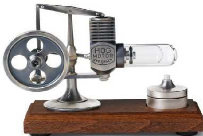
Figura 50: Modelo del motor de Stirling.
