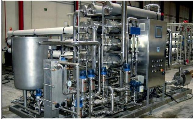
Ilustración 8, equipo de microfiltración
