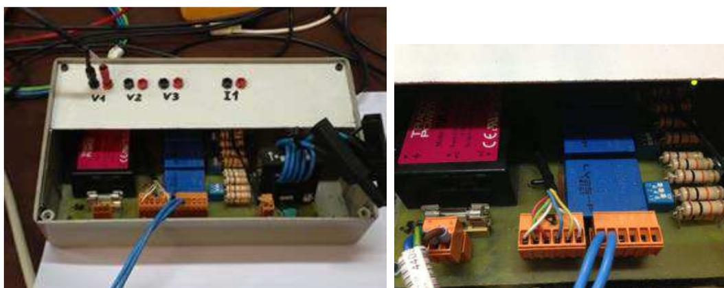
**Figura 4.8.** Transductor de tensión a la izquierda. Detalle del transductor a la derecha.
