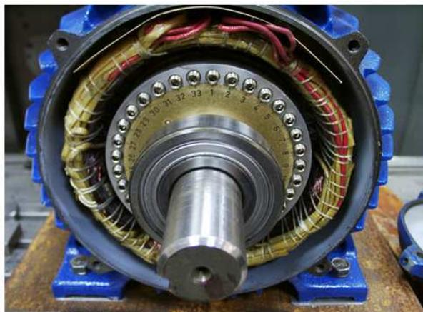
Figura 2.5. Rotor Jaula de ardillas de 33 barras [JAR09].
