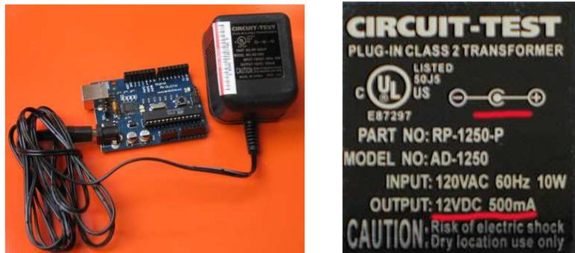
Fig.2 Arduino UNO conectado a una fuente externa.
