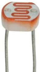
Una fotorresistencia o LDR (Light-Dependent Resistor) es un componente electrónico cuya resistencia varía en función de la luz. El valor de la resistencia eléctrica de un LDR es bajo cuando hay luz incidiendo en él y muy alto cuando está a oscuras.
