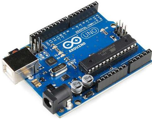
El **Arduino UNO** es una placa microcontrolada basada en el ATmega328. Tiene 14 Entradas/Salidas digitales (6 de ellas pueden emplearse como salidas PWM), 6 entradas analógicas, conector USB, clavija hembra tipo Jack, conector ICSP (In-Circuit Serial Programming) y botón de reset. La posición de todos estos elementos queda reflejada en la imagen de la Fig.3.
