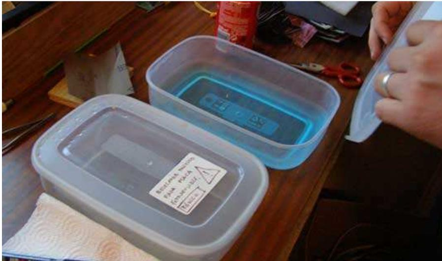
Fig.50 Cubetas con líquido revelador y atacador
