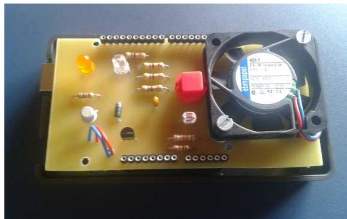
Fig.47 Placa de test gestionada por Arduino
