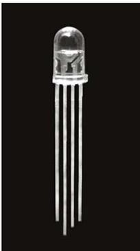
El LED RGB utilizado en este proyecto es el representado en la Fig.23; posee 4 patillas, siendo la más larga el ánodo del dispositivo que debe ir conectado a los 5V que suministra la tarjeta Arduino. El resto de patillas corresponden a los colores **Rojo**, **Azul** y **Verde** según se aprecia en la representación, y cada una debe ir conectada en serie con una resistencia de  $470\Omega$ , tal y como se indica en el Circuito 2 del Apéndice A.
