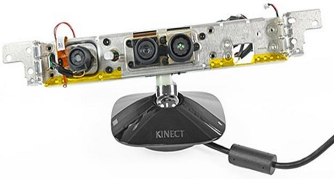
Figura 2.2 El sensor Kinect por dentro
