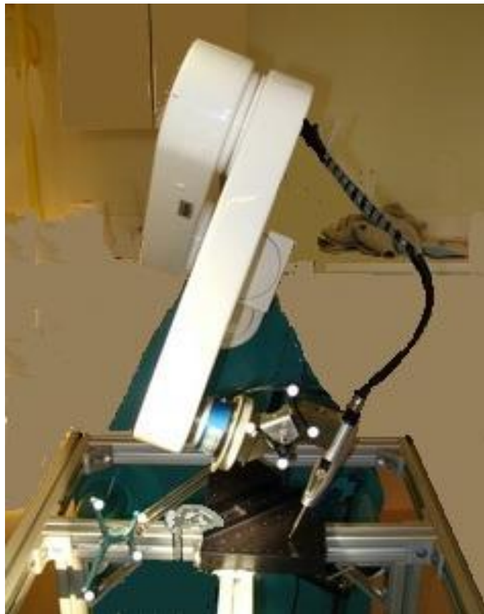
Figura 4.6 Sistema Robótico Neuromate [31]
