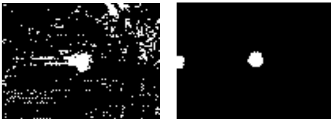
Figura 5.8 Imagen binaria creada con los rangos superior e inferior de matiz (izquierda) y saturación (derecha)
