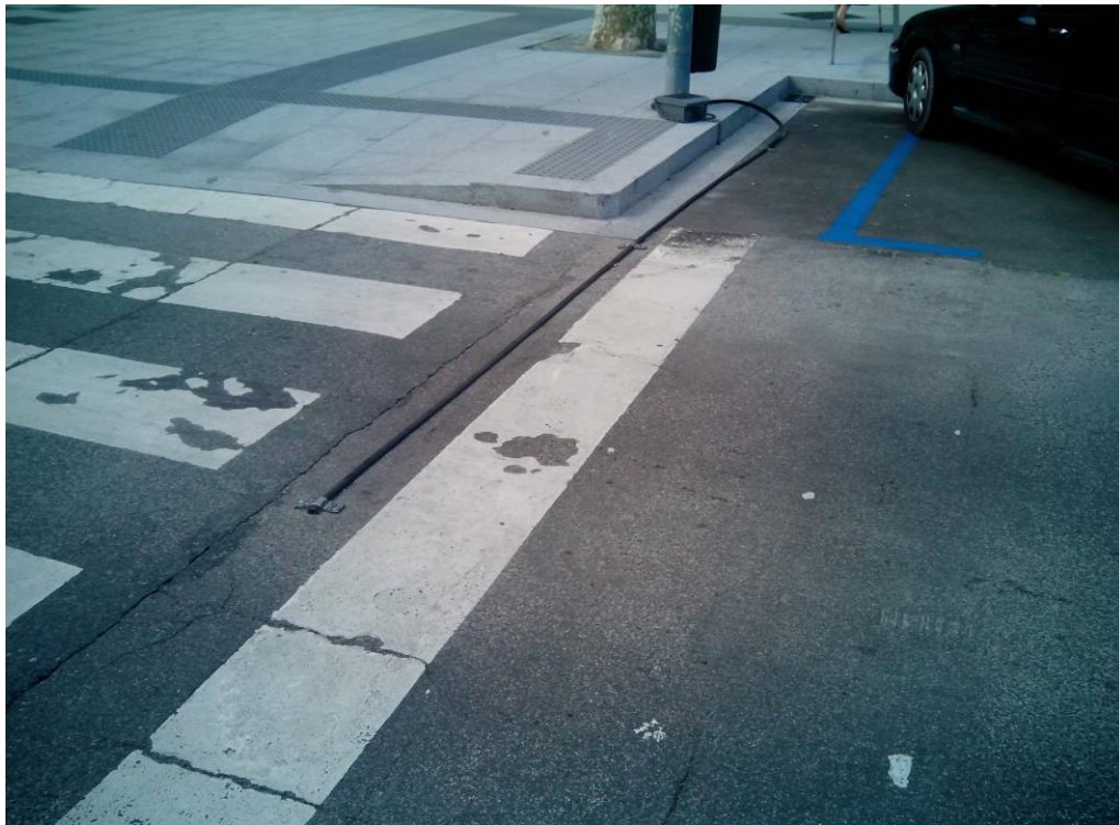
Figura 1.2.: Tubo neumático colocado en la calzada
