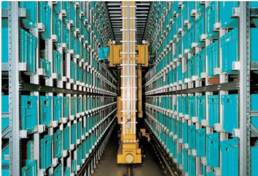
Figura 4.3.: Transelevador en almacén robotizado
