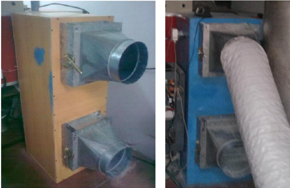
Figura III.7: Plénium conectado a la UTA que simula el caudal de ventilación.
