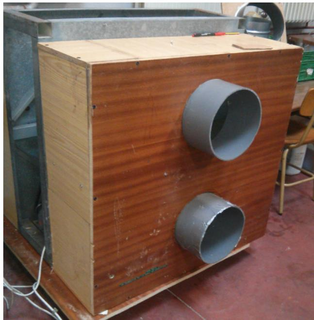
Figura III.6: Plenum de distribución anclado a una de las caras del recuperador.
