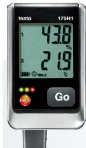
Figura III.10: Registrador de datos de temperatura y humedad
