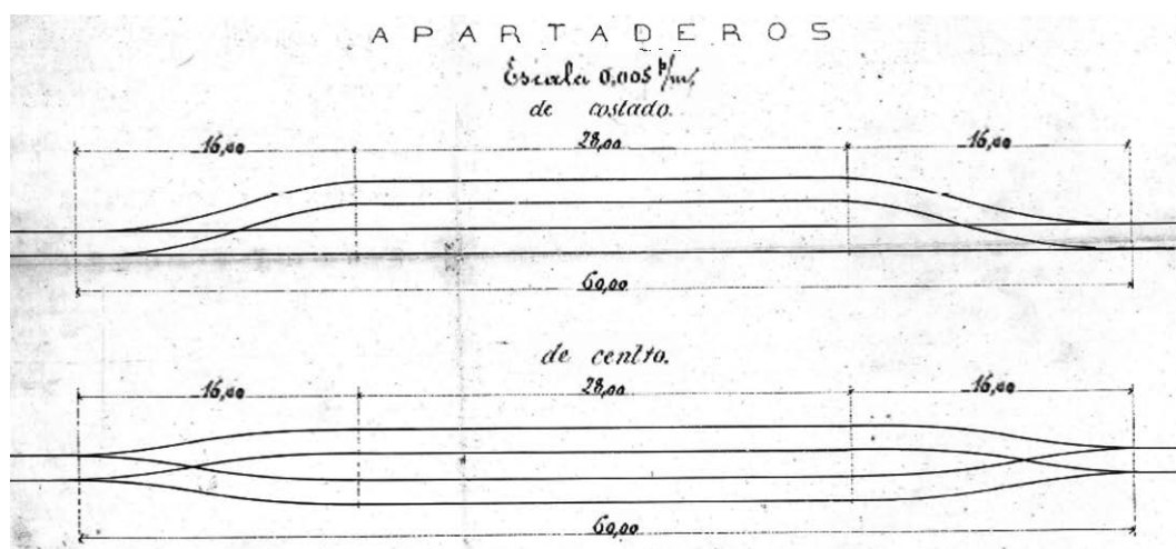
(60) Dimensiones de los dos tipos de apeaderos proyectados para el tranvía por la Sociedad Valero Morales y Compañía. 15
