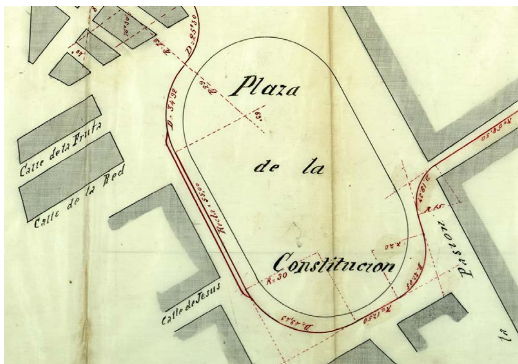
(69) Apartadero situado en la Plaza de la Constitución, con las medidas de las rectas y las curvas. 8
