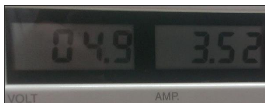
Figura 3.14 – Consumo placa adaptación de niveles con driver de potencia
