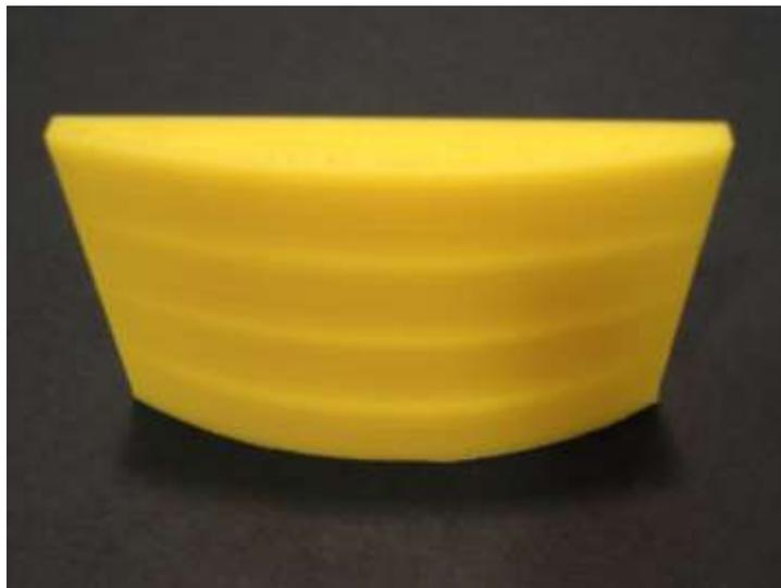
Figura 7.3.4: Pieza "Curvatura" impresa en vertical
