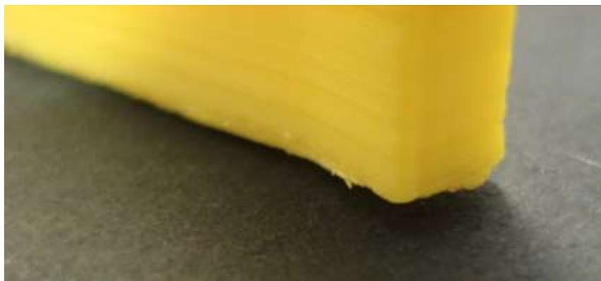
Figura7.4.7: Esquina levantada en la pieza "Inclinación" impresa en vertical
