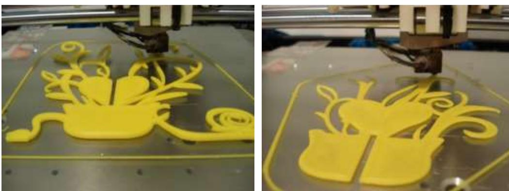
Figura 7.8.10: Proceso de impresión de las dos partes superiores de la pieza "Planta"
