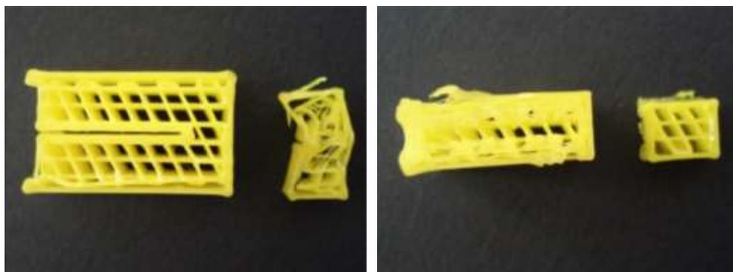
Figura 7.6.11: Material de aporte en la pieza "Vuelo" una vez retirado de la pieza
