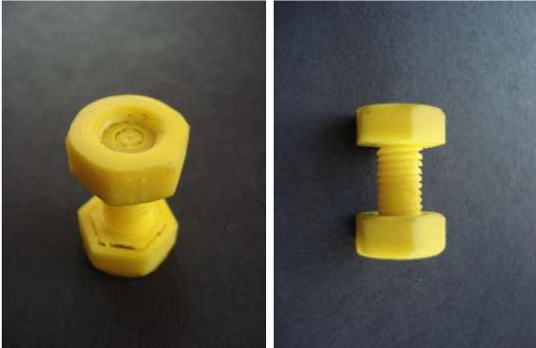
Figura 7.8.9: "Tornillo M10" y "Tuerca m10" enroscados entre sí
