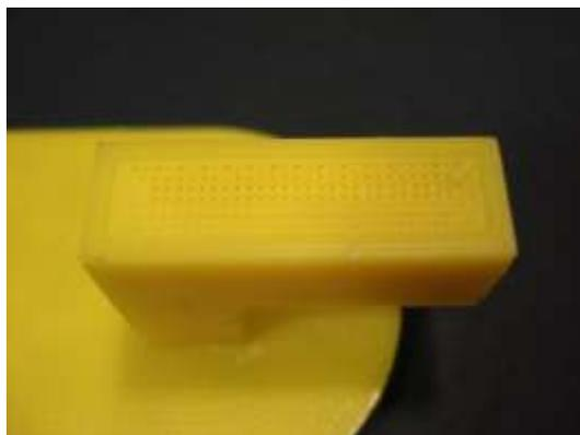
Figura 7.7.15: Huecos aparecidos en la pieza "Vuelo" impresa con material de aporte
