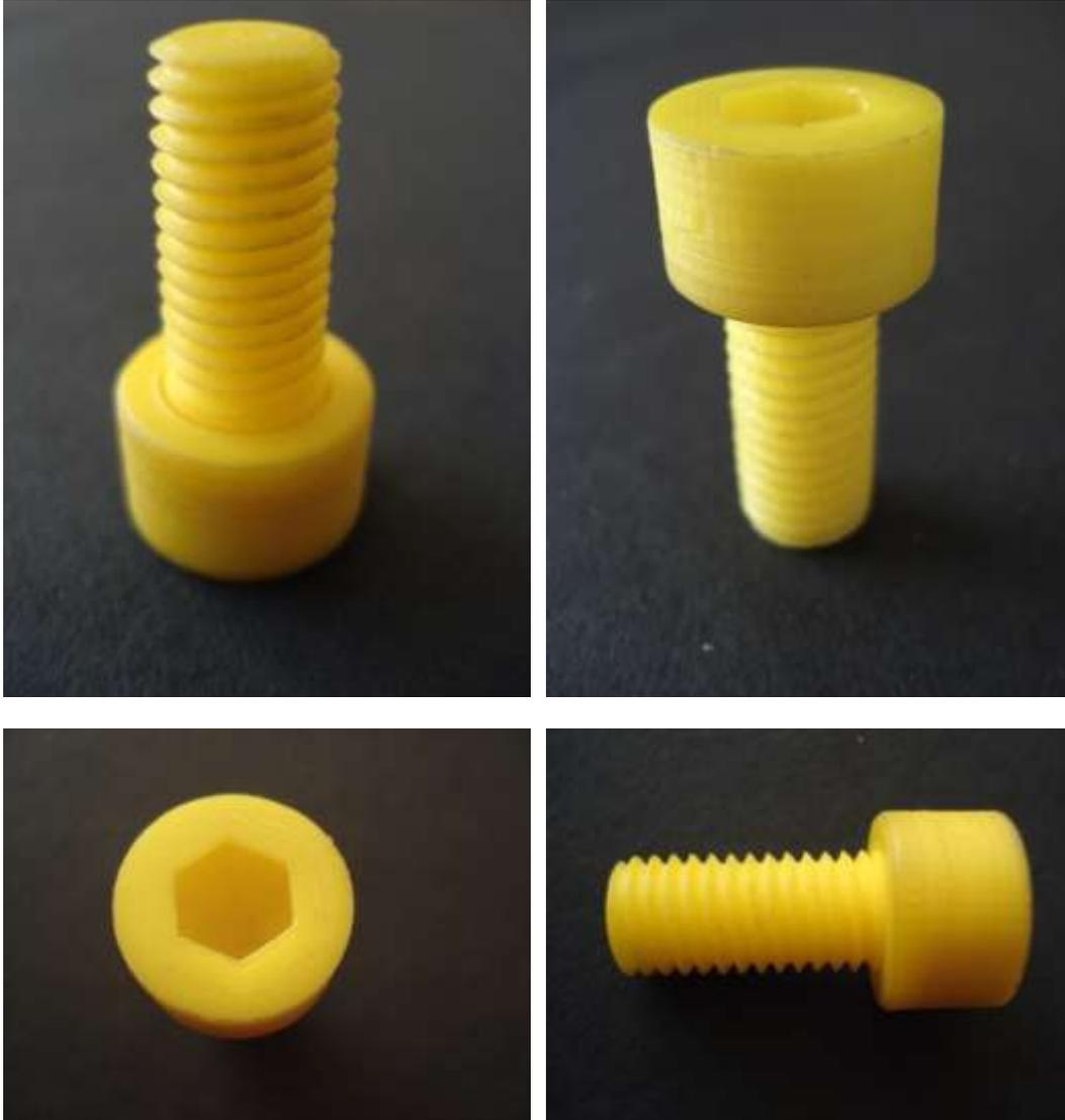
Figura 7.8.4: Pieza "Tornillo allen M10" una vez impresa
