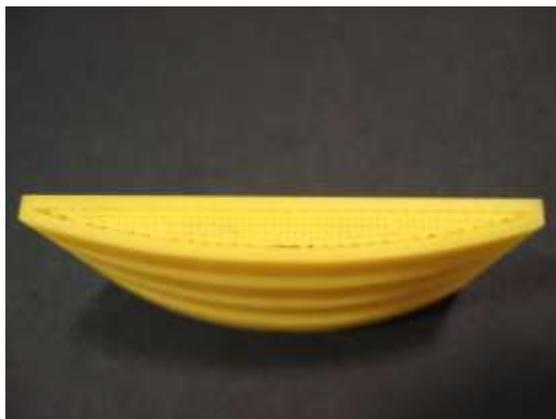
Figura 7.7.16: Huecos aparecidos en la pieza "Curvatura" impresa en vertical
