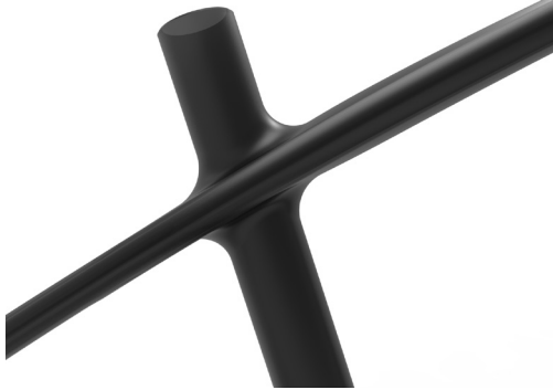
Figura 20. Unión tubo del sillín, con tubo superior y vainas.
