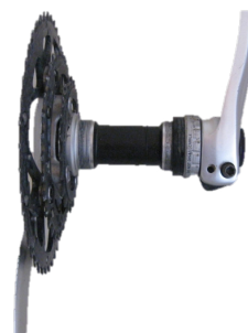
Figura 52. Conjunto plato, eje pedalier, cazoleta, biela.
