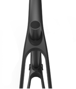
Figura 20.1 Zona de uniones. Vainas con tubos superior, inferior y del sillín
