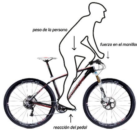
Figura 45. Disposición de las cargas producidas por el ciclista
