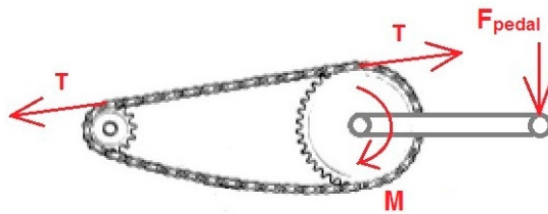
Figura 48. Fuerzas generadas por el sistema plato-piñón-cadena-biela
