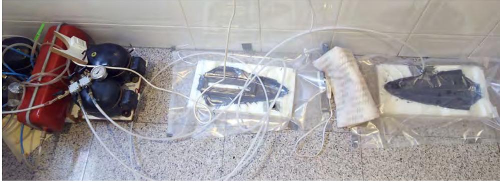
*Imagen de la maquina de vacío, realizando su trabajo sobre las dos mitades del molde a la vez.*
