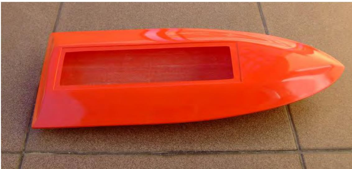
• Descripción: El casco mini-eco está fabricado de fibra de vidrio y resina epoxy reforzada. Este modelo dispone de un espacio para el canal de inundación por lo que tiene posibilidad self-righting por cámara de agua. El modelo INDY está diseñado para la clase MINI-ECO-EXPERT.
