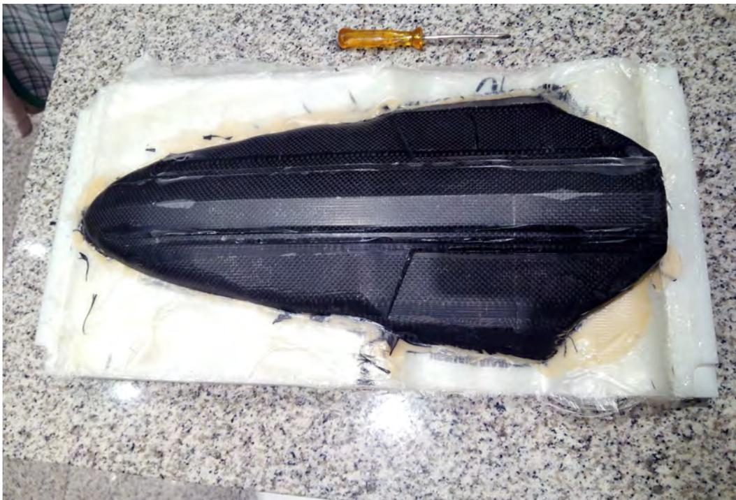
*En las imágenes se puede observar como se ha realizado el modelo, en concreto este punto de trabajo sería el punto 5 del Cuadro de precios descompuestos del nuevo modelo MiniEco Tarasca, con el que se obtiene el casco al unir las dos mitades del molde.*
