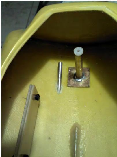
*Primeramente, sobre una cinta de carroceros, se marcan las cotas de posición de la bocina del eje y del timón y se abre con el disco de corte para estratificados de la dremel.*
