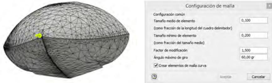
• La configuración de la malla 2 (que vemos en la imagen a continuación) es como la primera malla; donde únicamente bajamos el valor medio del tamaño del elemento hasta 0´05. Como se puede apreciar en las imágenes, la malla es mucho mas densa.
