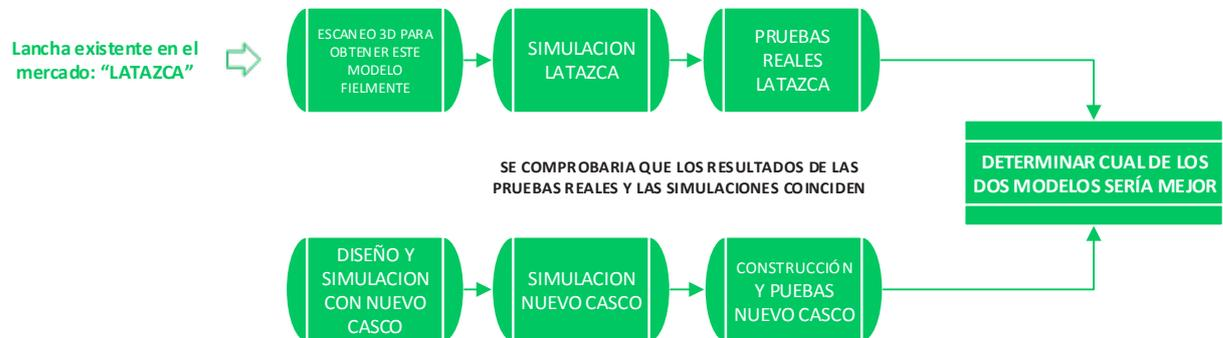
El nuevo planteamiento del trabajo consistiría en trabajar de forma paralela el desarrollo del nuevo modelo, con sus simulaciones, sus pruebas reales y el escaneo y análisis del modelo comercial.
