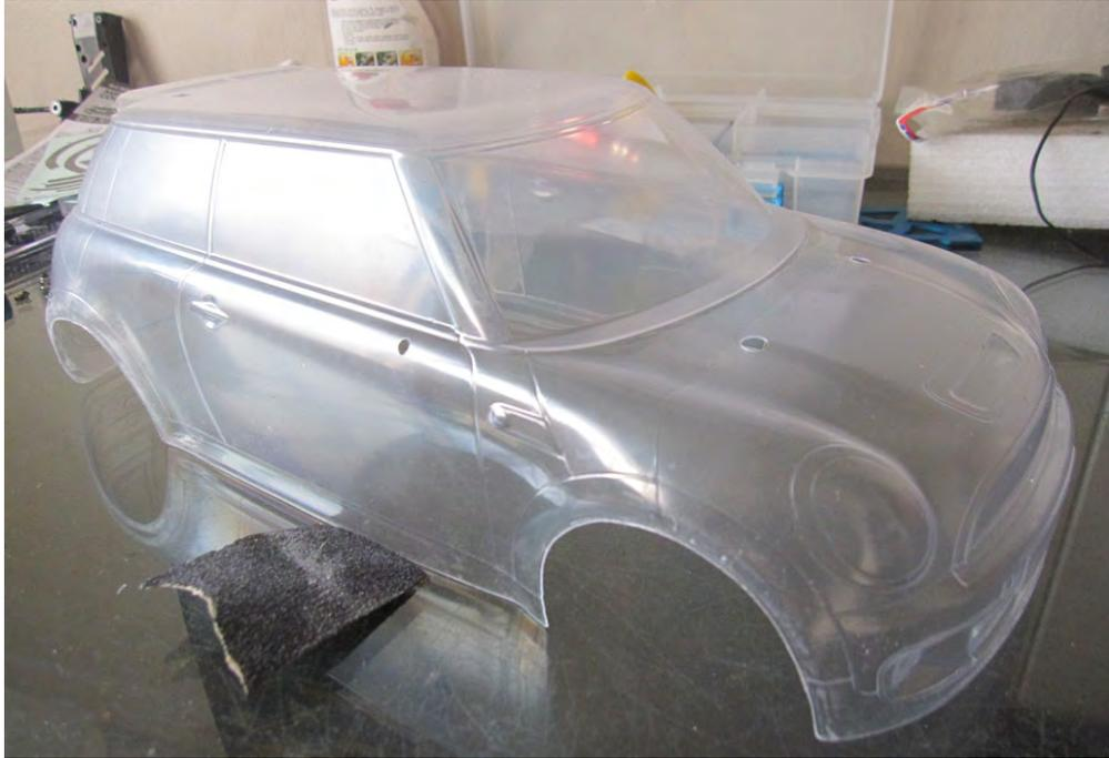
*Carcasa de un coche R/C fabricada en Lexan®.*
