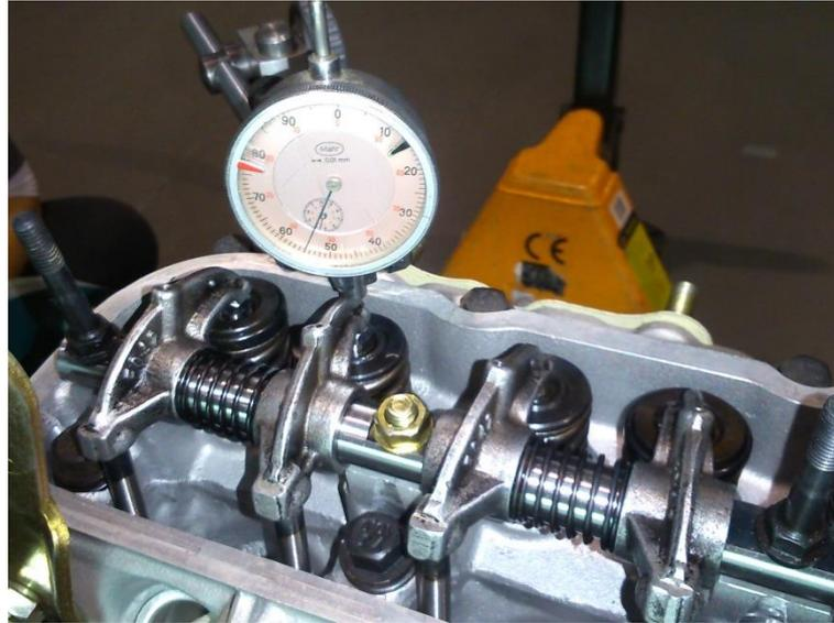
Figura 2.8.- Medición del levantamiento de válvulas mediante un palpador y sistema de distribución.
