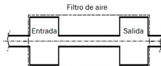
Figura 3.25.-Modelo de cálculo del filtro de aire. [10]
